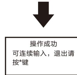
**▲注意** 当提示操作成功,如此时是设置的密码,就还可以连续设置另外不同的密码,如果是指纹就可以连续设置不同的指纹,后面连续设置的用户编号都为相同,如果要设为不同的用户编号,按\*键返回上一级菜单第二步,按提示重新设置,这样系统将会生成不同的用户编号,门锁系统可同时录入密码+卡+遥控器共1000个,指纹300枚。
